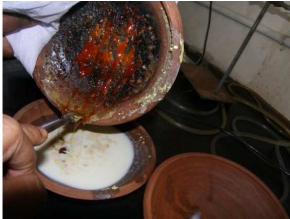
Fig. 3: Pouring melted Sulphur
