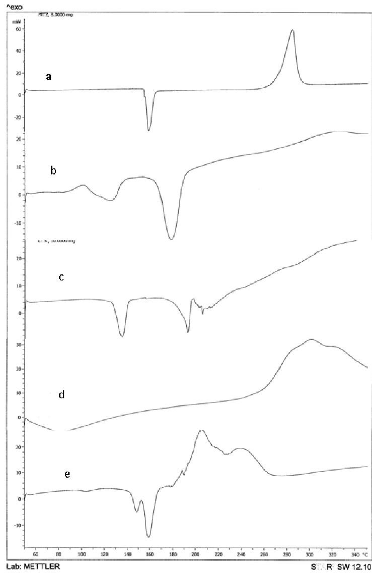
**Fig. 2:** DSC thermograms of (a) metronidazole (b) chitosan (c) lactose (d) acacia gum and (e) Formulation F2
